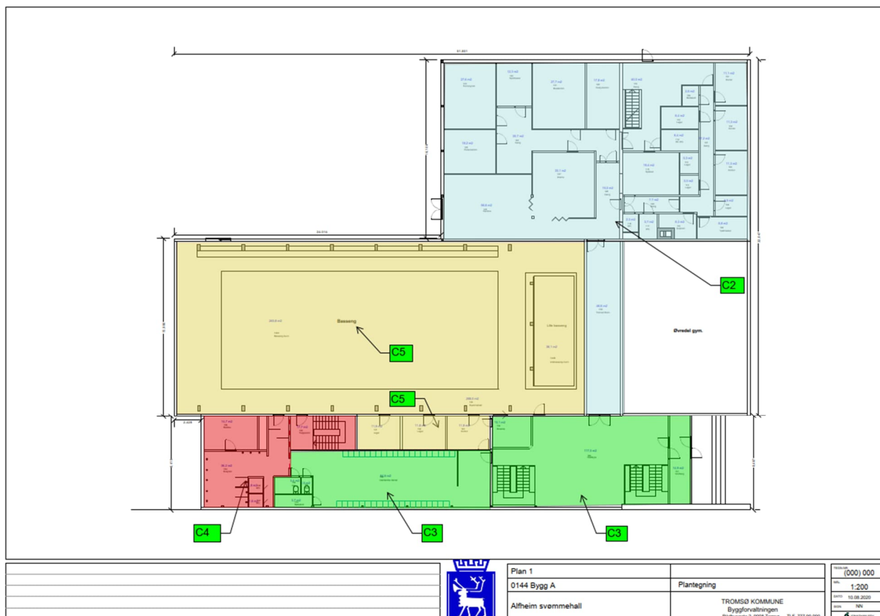
Figur 3 Forslag oppdeling i soner etter korrosjonsklasse
